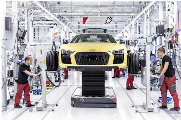
*Abbildung 1.1: Fahrerlose Transportsysteme der Audi R8 Produktionsanlage [Med18].*
