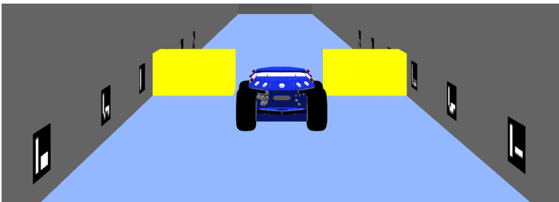
*Abbildung 6.1: Exemplarischer Fluraufbau in der Simulationsumgebung VEROSIM mit AR-Marker an den Flurwänden und gelben Boxen als Kollisionsobjekte.*
