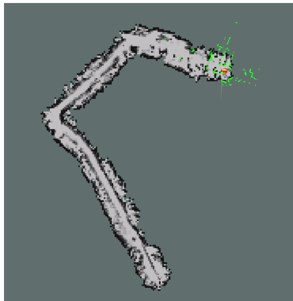
ABBILDUNG 3.8: SLAM in der Simulation mit den bagfiles des IPA BMW i3
